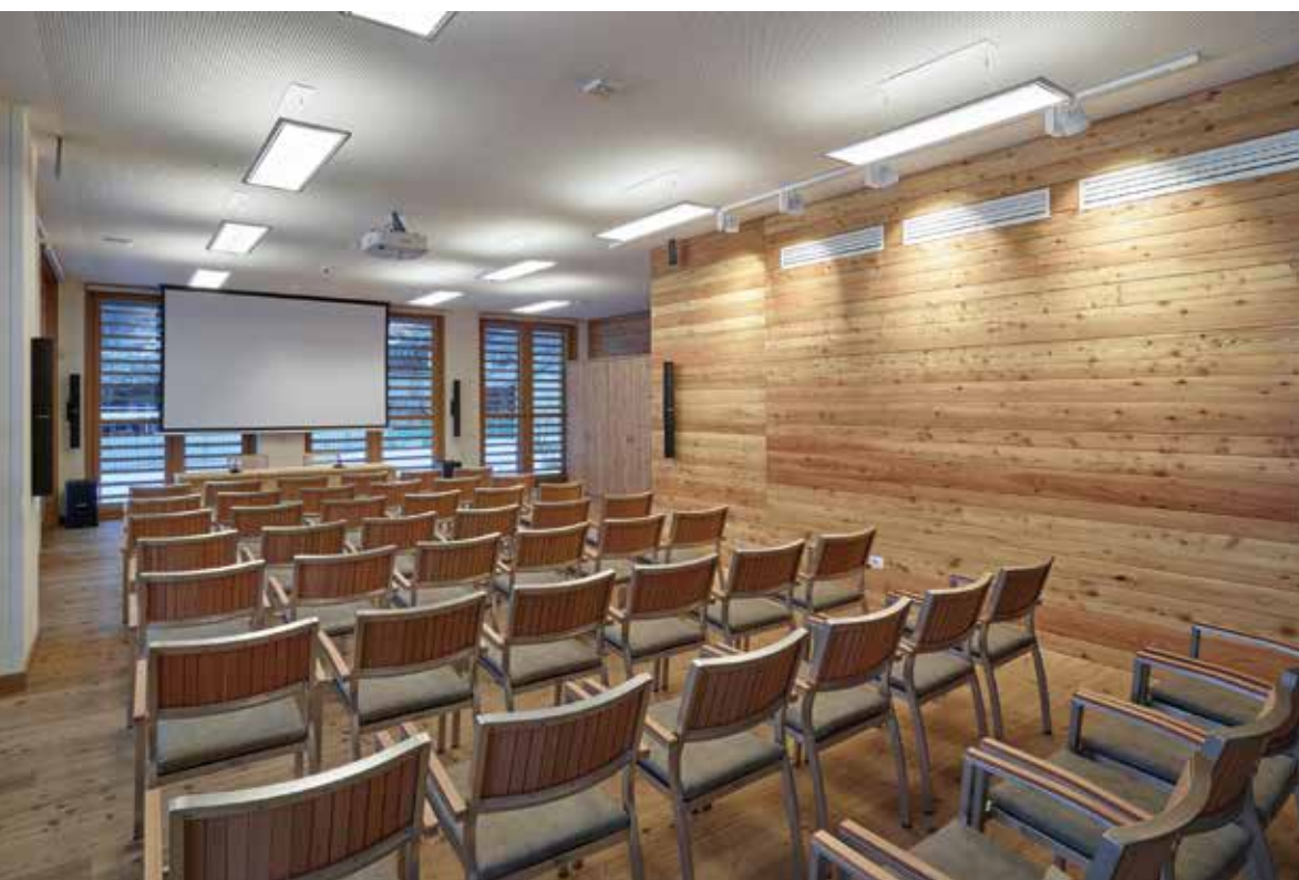
La struttura è perfettamente isolata dal punto di vista sia termico che acustico grazie al cappotto termico in lana di roccia di 13 cm di spessore
